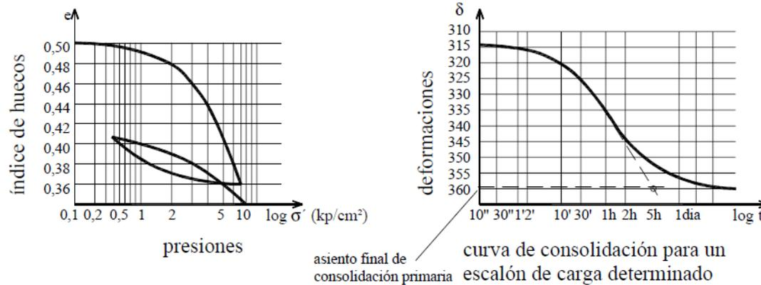
Como resultado del ensayo se obtienen las curvas edométricas, y de ella los índices que califican la compresibilidad del suelo:
