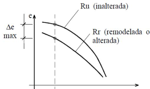
La presión de preconsolidación coincide con el valor de las abscisas correspondiente a la mayor diferencia de índice de huecos entre las curvas edométricas de muestras de arcilla inalteradas y reamasadas.
