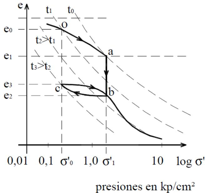
Si en “O” se añade una carga (se construye un edificio o estructura) se producirá un  $\Delta\sigma'$  instantáneo que produce:
