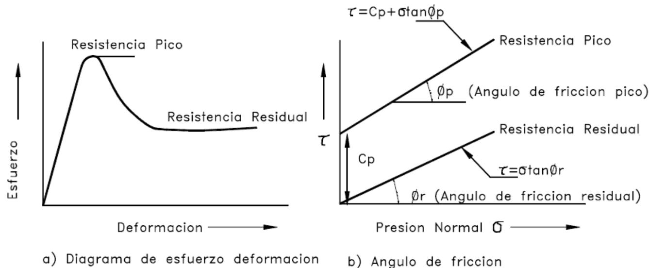
La resistencia pico es la máxima resistencia al corte que posee el material que no ha fallado previamente.
