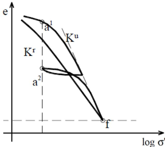
Considerando las curvas  $K_r$  y los puntos representativos del estado tensión-deformación, y en función de su posición relativa, pueden determinarse si el suelo es sobreconsolidado o no:
