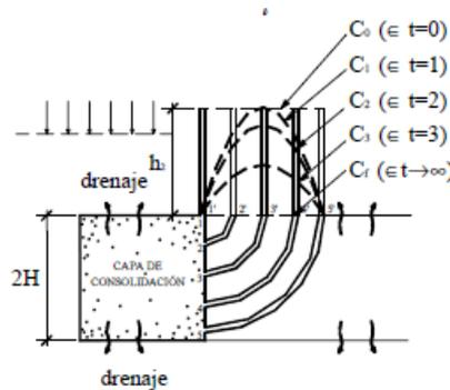
En  $t=0$  la isocrona es horizontal y de altura igual a la presión, que es absorbida por el agua como sobrepresión hidrostática.
